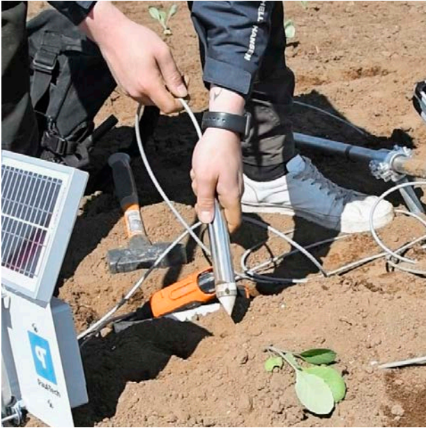
Anturit sijoitettiin ohjeiden mukaan 8 ja 20 cm syvyyteen.
