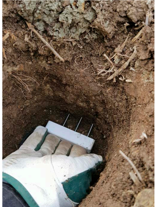
A41T12-sääasemaan on integroitu maaperäsensori, joka mittaa maan lämpötilan lisäksi maan kosteutta ja johtokykyä.
